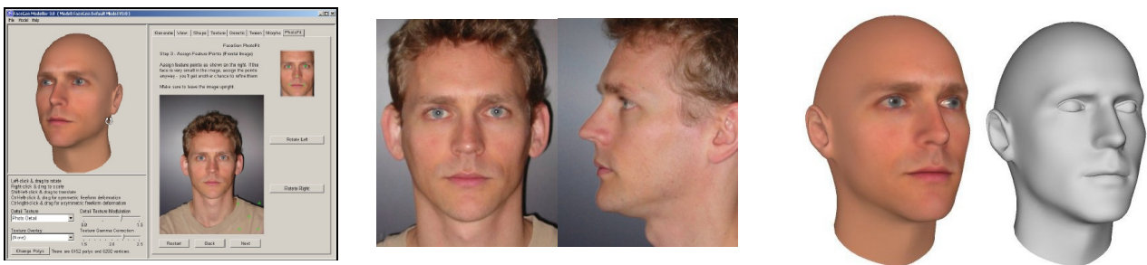
Bild 6. Gesicht-Modeler Facegen . Links: Snapshot von Software. Mitte: benutzte Bilder für die Erstellung des virtuellen Kopfes. Rechts: entstandenes 3D Gesicht-Modell (Bilder von Singular Inversions).
